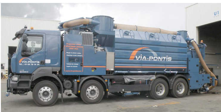
Matériel pour dégommage des pistes d'aéroport
